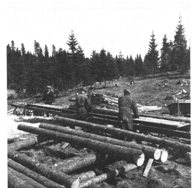
Kuva 1. Sahaus siirrettävällä kenttäpyörösahalla. Oikealla apusahaaja, keskellä etusahaaja sekä vasemmalla valmiin sahatavaran ja sahausjätteen poistaja
