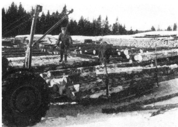
Kuva 21. Tukkikuorman purkaminen 3-kerroksiseen telakasaan Kornissa.
