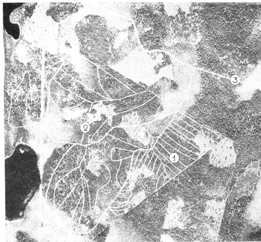
Kuva 5. Ristimäensalon työmaan palstatieverkko. — 1. alue, jolla pinotavara hakattiin palstateiden varteen. — 2. alue, jolla käytettiin vintturijuontoa. — 3. varsitie. Fig. 5. The strip road network of the Ristimäensalo work site. — 1. The area in which the cordwood was logged alongside the strip roads. — 2. The area in which winch skidding was employed. — 3. The main haulage road.
