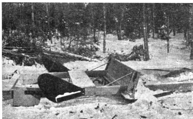
Kuva 9. Traktorivetoinen, ajoradan tasaamiseen tarkoitettu lana. Fig. 9. Tractor-drawn drag for levelling the roadway.
