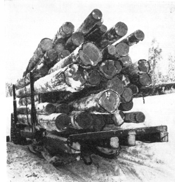
Kuva 19. Palstatieltä lähtenyt, n. 400 j 3 tukkikuorma Pelkosenniemen varsi tiellä. Fig. 19. A log load of some 400 cu.ft., which set off from a strip road, travelling on the main haulage road at Pelkosenniemi.
