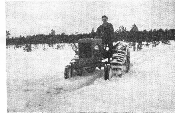
Kuva 7. Lumen tiivistäminen puolitelaketjuilla varustetulla pyörätraktorilla.
