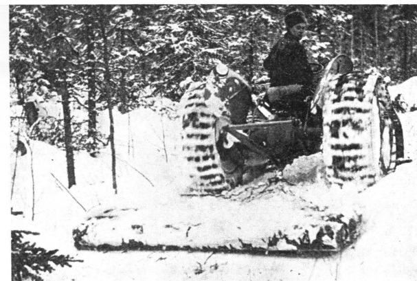
Kuva 10. Lumen vähyden vuoksi käytettiin Ristimäensalon palstateilla tilapäislanaa. Fig. 10. Owing to the thin snow cover an improvised drag was used on the strip roads at Ristimäensalo.
